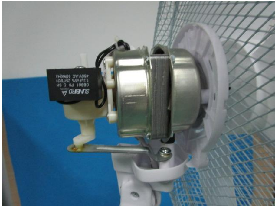
Fan motor and motor capacitor
